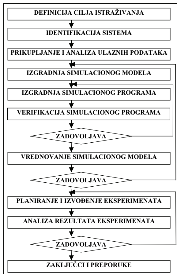
Slika 2. Dijagram toka simulacionog procesa
