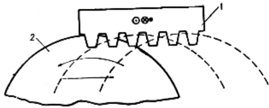
Slika 4.: Princip rada rendisaljke za zupčanike Mag
