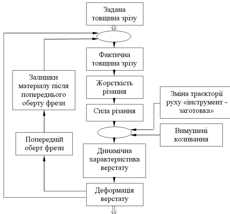
Рис. 1. Блок-схема взаємних зв'язків між товщиною шару, що видаляється, жорсткістю різання і динамікою верстату
