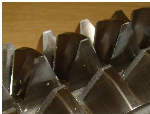
Slika 5. Detalj pohabanih zuba odvalnog glodala
