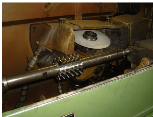
Slika 7. Oštrenje odvalnog glodala na mašini KLINGELNBERG
