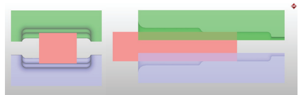
Slika 6. Gravura za predoblikovanje radi rasporeda masa sa ravnim poprečnim presekom
