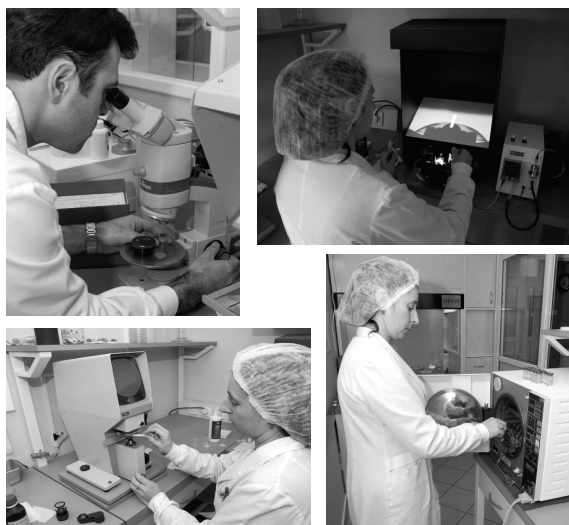
Slika 11. Radijuskop (gore levo), fokometar (gore desno), šedograf (dole levo) i parna sterilizacija sočiva (dole desno)
