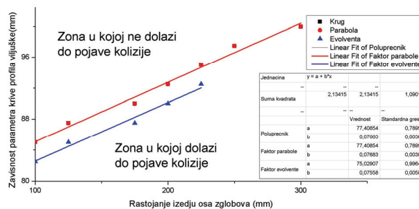
Slika 5. Funkcionalna zavisnost parametara viljuške univerzalnog zgloba i zone pojave kolizije za različite tipove krivih
