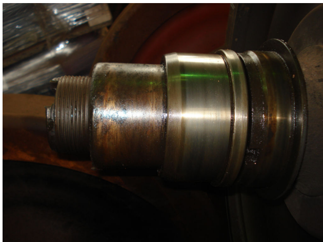
Sl.2 Oštećenja ležišta (rukavca) korozijom i nagrizanjem
