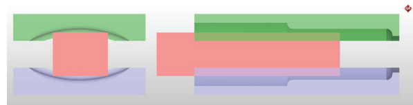
Slika 5. Gravura za predoblikovanje radi rasporeda masa sa elipsastim poprečnim presekom
