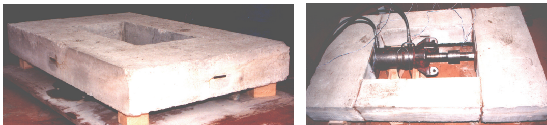
Слика 4, Носеће структуре машина израђене од композитног материјала гвожђе-бетон
