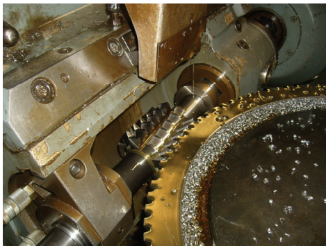
Slika 4. Ozubljenje pužnog točka odvalnim glodalom na mašini PFAUTER 630
